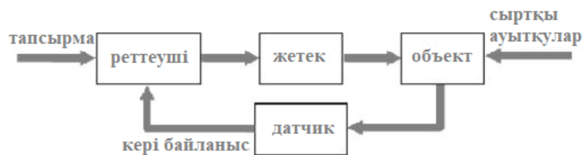
1.12 Сурет – Автоматты басқару жүйесінің блок-схемасы
